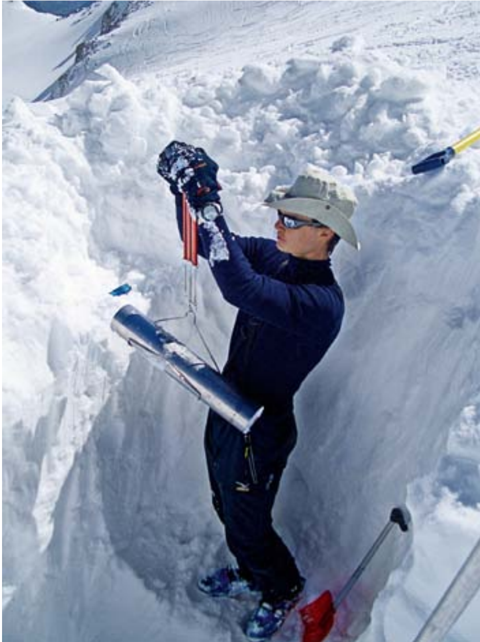
Messung der Schneedichte am Pizolgletscher. Foto: Mauro Werder
