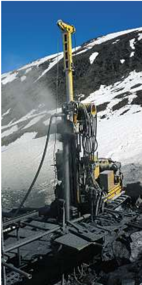
En cas de forage dans un pergélisol contenant de la glace, on utilise de l'air froid et sec afin que celle-ci ne fonde pas
