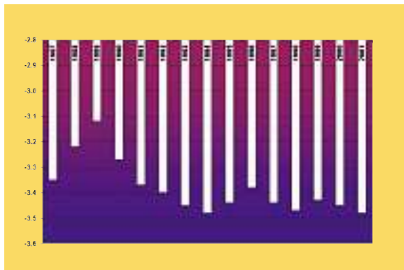
Fig. 1 Entwicklung der maximalen Tiefe der Auftauschicht im Permafrost des Blockgletschers von Murtèl/Corvatsch (GR) zwischen 1988 und 2001. Über eine so kurze Dauer ist keine Tendenz ablesbar. Die Messungen müssen über einen längeren Zeitraum erfolgen.
